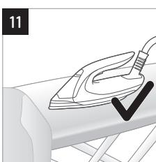
Triikimise ajal saate triikraua asetada kas alusele või horisontaalselt triikimislauale. Tänu ActiveSense tehnoloogiale ei kahjusta triikraua tald triikimislaua katet (joonis 11).
