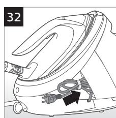
**6** Pliază cablul de alimentare, prinde-l cu banda adezivă furnizată și introdu-l în compartimentul de depozitare a cablului (fig. 32).
