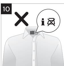
Pre určité jemné textílie a povrchovú úpravu (napr. semiš, zamat, kovové tkanie, filtre) sa odporúča naparovanie v malej vzdialosti nad odevom. Látky s týmito symbolmi nie sú vhodné na žehlenie (obr. 10). Patria sem syntetické vlákna, ako spandex či elastan, látky obsahujúce spandex a polyolefíny.
