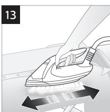
Pri načinu pametnega samodejnega izpusta pare izpuščanje pare med premikanjem likalnika poteka samodejno ter se prekine, ko likalnik miruje (slika 13). Če želite v tem načinu vklopiti paro, ko likalnik miruje, pritisnite sprožilnik pare.
