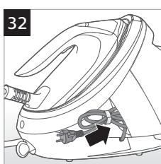
**6** Napajalni kabel zložite s priloženimi ježki in ga vstavite v prostor za shranjevanje kabla (slika 32).
