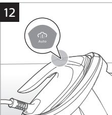
Aparatul este livrat cu funcția de generare automată intelligentă a aburului, mulțumită tehnologiei DynamiQ cu senzor, care recunoaște modul și momentul în care miști fierul de călcat. Când pornești aparatul, acest mod va fi activat implicit (fig. 12). În combinație cu tehnologia ActiveSense, fierul de călcat va genera în mod automat cantitatea potrivită de abur, în funcție de mișările tale și de tipul de material, fără a fi nevoie să folosești declanșatorul de abur.
