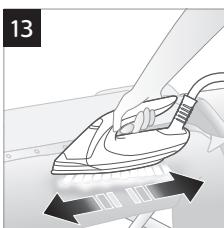
Στη λειτουργία έξυπνης αυτόματης παραγωγής ατμού, ο ατμός εξέρχεται αυτόματα όταν μετακινείτε το σίδερο και σταματά κάθε φορά που διακόπτετε την κίνησή του (Εικ. 13). Μπορείτε να πατήσετε τη σκανδάλη ατμού σε αυτήν τη λειτουργία, για να ενεργοποιήσετε τον ατμό όταν το σίδερο δεν κινείται.
