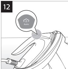
Η λειτουργία έξυπνης αυτόματης παραγωγής ατμού με τεχνολογία αισθητήρα DynamiQ αναγνωρίζει πότε και πώς κινείται το σίδερο. Όταν ενεργοποιείτε τη συσκευή, αυτή η λειτουργία ενεργοποιείται από προεπιλογή (Εικ. 12). Σε συνδυασμό με την τεχνολογία ActiveSense, το σίδερο παράγει αυτόματα την κατάλληλη ποσότητα ατμού ανάλογα με τις κινήσεις σας και τον τύπο υφάσματος, χωρίς να απαιτείται η χρήση της σκανδάλης ατμού.
