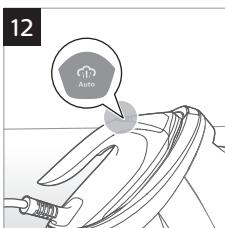
Vaš aparat ima funkcijo pametnega samodejnega izpusta pare, saj senzorska tehnologija DynamiQ zazna, kako in kdaj premikate likalnik. Ko vklopite aparat, se ta način privzeto aktivira (slika 12). V kombinaciji s tehnologijo ActiveSense bo likalnik samodejno izpuščal ustrezno količino pare glede na vaše premike in vrsto tkanine, ne da bi morali pri tem uporabiti sprožilnik pare.
