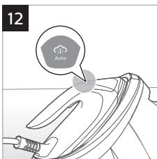
Vaš aparat dolazi s pametnim automatskim načinom rada za paru zahvaljujući tehnologiji senzora DynamiQ koja prepoznaže kako se i kada vaše glaćalo pomiče. Kad uključite aparat, taj način rada aktivirat će se po zadanim postavkama (sl. 12). U kombinaciji s tehnologijom ActiveSense, vaše će glaćalo automatski ispuštać odgovarajuću količinu pare temeljem vaših pokreta i vrste tkanine, bez potrebe za upotrebu gumba za paru.
