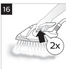
Функция "Паровой удар" предназначена для разглаживания самых жестких складок.
