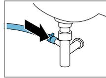
Зафиксируйте соединение хомутом (24-40 мм).
