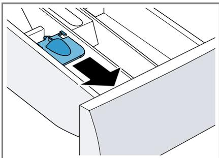
3. Прижмите и зафиксируйте дозатор.
