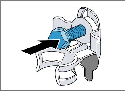
4. Установите сетевой кабель в крепление ① и затяните все 4 винта транспортировочных креплений ключом SW13②.
