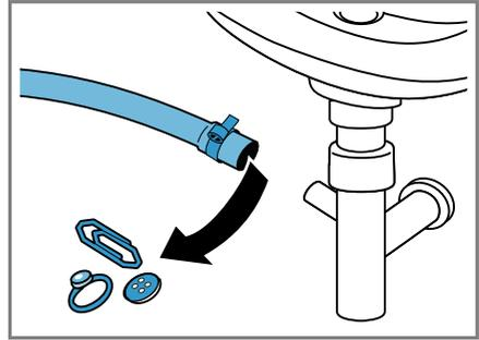
5. Подсоедините сливной шланг и зафиксируйте место соединения хомутом.
