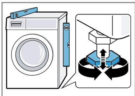
Все ножки прибора должны прочно стоять на полу.
