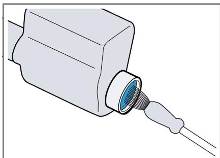
3. Подсоедините шланг для подачи воды и проверьте герметичность соединения.
