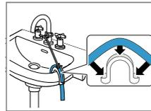
Зафиксируйте и закрепите скобой сливной шланг.
