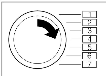
2. Нажмите на **Reduce Spin**
