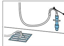
Зафиксируйте и закрепите скобой сливной шланг.
