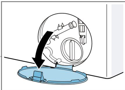
5. Снимите дверцу для технического обслуживания.
